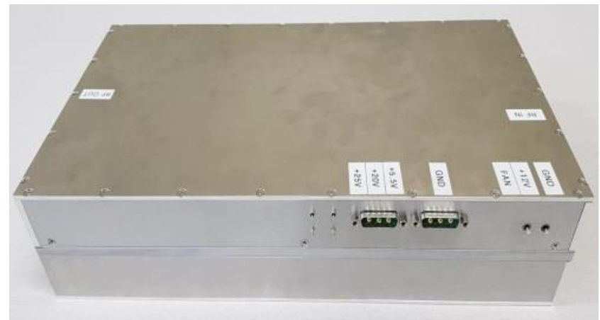
< ETRI GaN 20W SSPA 모듈 내부사진 (좌), 외부사진 (우) >
